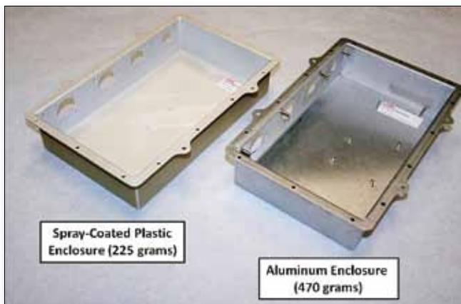
Los revestimientos epoxi altamente conductores permiten lograr niveles de blindaje similares al aluminio con tan solo una fracción del peso de los cuerpos envolventes tradicionales. Esta fotografía muestra el ahorro de peso logrado mediante la conversión de un cuerpo envolvente de aluminio (derecha) a un cuerpo envolvente termoplástico (izquierda), que ha sido pulverizado con el nuevo revestimiento epoxi.
