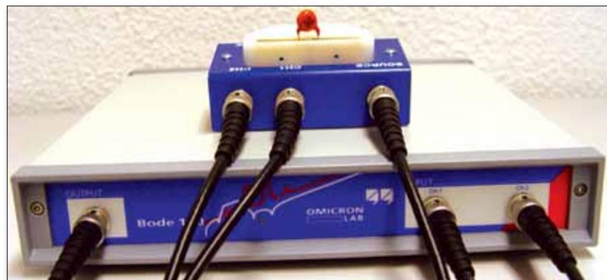
Bild 4: VNA mit Impedanz Adapter
