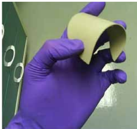
将高导电性环氧树脂涂层应用到塑料基板上
