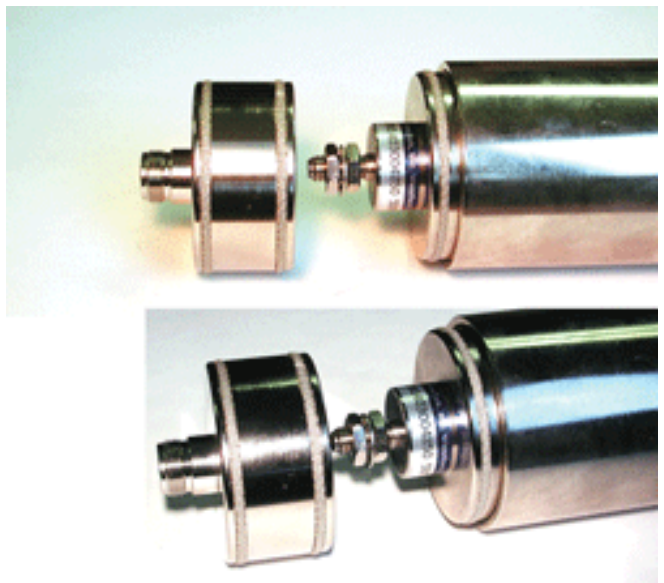
图8 安装在测试固定件中的一个HPR滤波器
