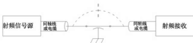
图4 当测量插入损耗时通过DUT的耦合
