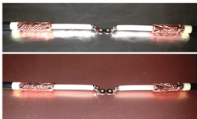
图5 接地DUT的连接测试导线
